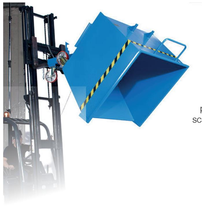
La benna completamente ribaltabile è costituita con tubolari e lamiera d'acciaio con ruote in funzione della portata adatta ad essere affiancata a macchine operatrici quali torni, frese e presse.
